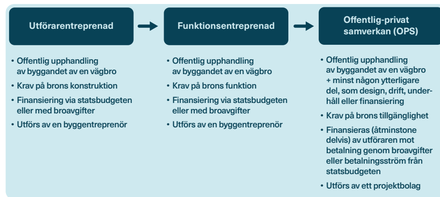
Figur 1. Olika typupplägg att organisera bygget av en vägbro.
